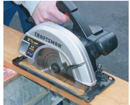
Fotografía 7.1 El diseño del eje de una sierra circular debe tomar en cuenta las fuerzas internas que resultan de las fuerzas aplicadas a los dientes de la cuchilla. En un punto dado del eje, estas fuerzas internas son equivalentes a un sistema fuerza-par consistente en fuerzas axiales y cortantes y en un par que representa los momentos de corte y de torsión.
