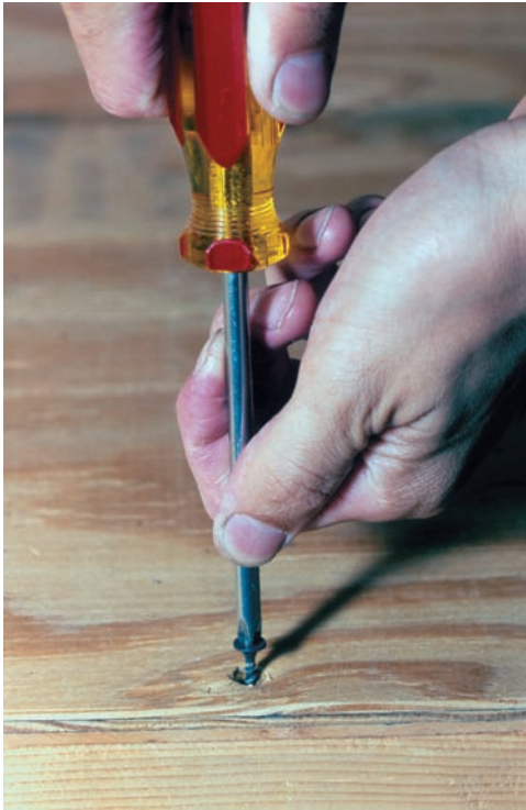
Fotografía 3.5 La acción de empujar y girar, asociadas con la operación de apretar un tornillo ilustra las líneas de acción colineales de la fuerza y el vector de par que constituyen una llave de torsión o torsor.
