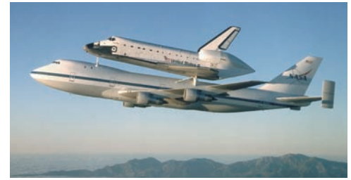
Fotografía 5.4 Cuando el Boeing 747 fue modificado para transportar un transbordador espacial , fue necesario determinar el centro de gravedad de cada nave para predecir las características del vuelo.
