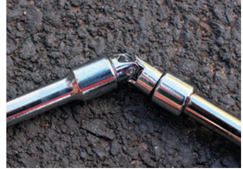
Fotografía 4.6 Las juntas universales que se encuentran comúnmente en las flechas motrices de los autos y camiones de tracción trasera, permiten la transmisión del movimiento rotacional entre dos ejes no colineales.
