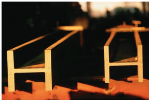
Fotografía 9.1 En la figura 9.13 se tabularon los datos de una pequeña muestra de todas las formas de acero laminado que se encuentran con facilidad. En la fotografía se muestran dos ejemplos de vigas de patín ancho que se usan en la construcción de edificios.
