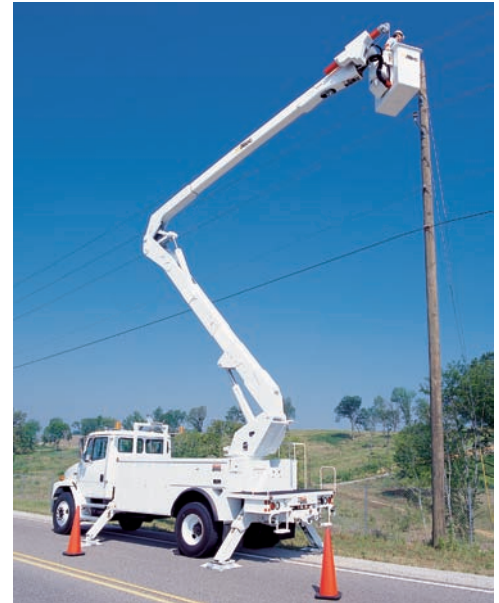
Fotografía 10.1 Las fuerzas ejercidas por los cilindros hidráulicos para posicionar el elevador de canasta mostrado en la fotografía pueden determinarse de manera efectiva mediante el método del trabajo virtual; lo anterior es posible porque existe una relación simple entre los desplazamientos de los puntos de aplicación de las fuerzas que actúan sobre los elementos del elevador.
