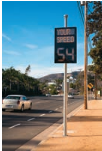
FIGURA 2.8 Medición de la velocidad de vehículos que pasan.
