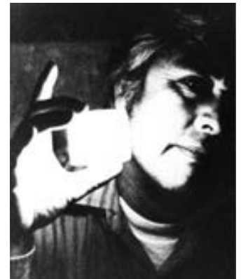
FIGURA 18.18 La baldosa cerámica de calor blanco ( 1\,260^\circ\text{C} ) usada para el sistema de protección térmica del Transbordador Espacial se sostiene con una mano desprotegida.
