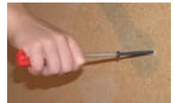
FIGURA 10.24 Atornillando un tornillo para yeso en un bloque de madera.
