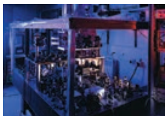
FIGURA 1.6 Reloj atómico de fuente de cesio en el NIST.
