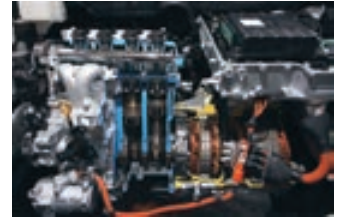
FIGURA 20.12 El motor de gasolina y el motor eléctrico de un automóvil híbrido.
