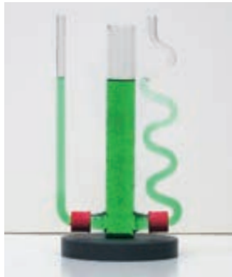
FIGURA 13.14 Tres columnas conectadas: el fluido sube hasta la misma altura en cada uno.
