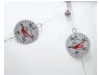
FIGURA 4.8 Una cuerda que pasa por una polea, con dispositivos de medición de fuerza que muestran que la magnitud de la fuerza es constante a lo largo de toda la cuerda.
