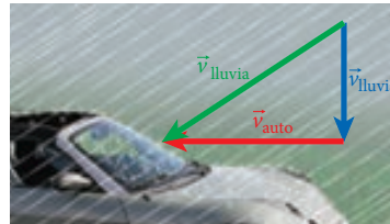
FIGURA 3.19 El vector velocidad \vec{v}'_{\text{lluvia}} de la lluvia como se observa desde el interior del auto en movimiento.
