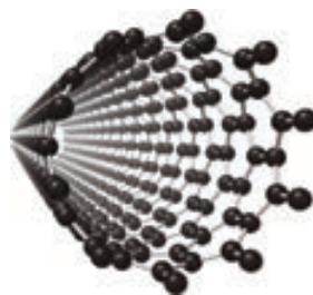
FIGURA 13.3 Nanoestructuras que consisten de disposiciones de átomos de carbono: a) fullereno, o buckyesfera; b) nanotubo de carbono.
