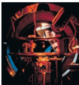
FIGURA 17.8 Dispositivo de enfriamiento por láser para enfriar átomos de sodio atrapados.
