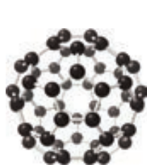
FIGURA 13.3 Nanoestructuras que consisten de disposiciones de átomos de carbono: a) fullereno, o buckyesfera; b) nanotubo de carbono.
