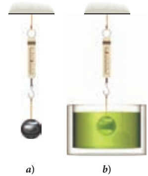
FIGURA 13.48 a) Una esfera de aluminio suspendida en el aire. b) La esfera de aluminio está sumergida en un líquido desconocido.
