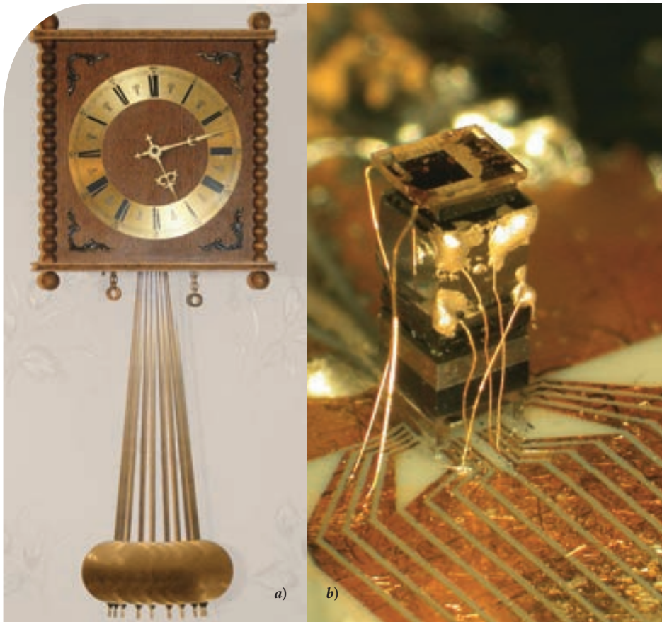
FIGURA 14.1 Oscilaciones armónicas usadas para medir el tiempo. a) Fotografía de exposición múltiple de un antiguo reloj de péndulo. b) El reloj atómico más pequeño del mundo del National Institute of Standards and Technology y en el cual los átomos de cesio realizan 9.2 mil millones de oscilaciones cada segundo. El reloj es del tamaño de un grano de arroz y es exacto hasta 1 parte en 10 mil millones, o en menos de 1 segundo en un periodo de 300 años.
