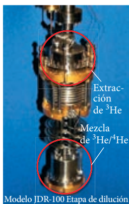
FIGURA 17.7 a) Un refrigerador de dilución comercial. b) Interior de un refrigerador de dilución con el recipiente de ^3\text{He}/^4\text{He} (mezclador) y el recipiente de extracción de ^3\text{He} (alambique).
