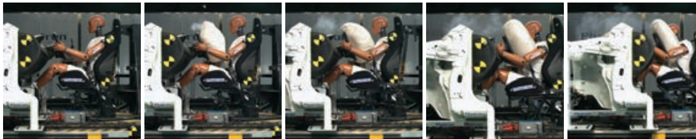
FIGURA 7.6 Secuencia en el tiempo que muestra una prueba de colisión y la función de las bolsas de aire, los cinturones de seguridad y las zonas de estrujamiento en la reducción de las fuerzas que actúan sobre el conductor durante un choque. Se puede ver, en la segunda fotografía de la secuencia, la bolsa de aire desplegándose.
