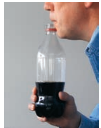
FIGURA 16.25 Excitación de un sonido resonante de una aproximación de un tubo semiabierto.
