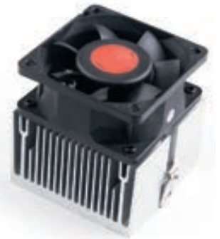
FIGURA 18.27 Tecnología de sumidero de calor activo y pasivo montado sobre la CPU de una computadora.
