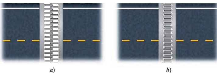
FIGURA 17.12 Juntas de dedo entre los segmentos de la calle: a) abiertas y b) cerradas.
