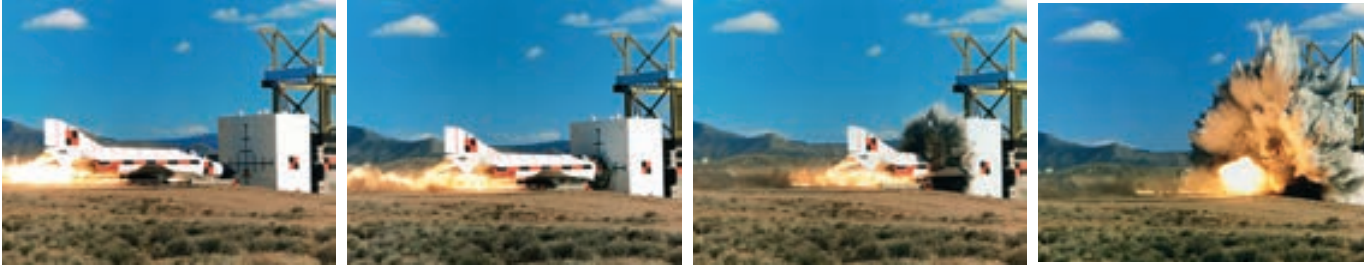
FIGURA 7.2 Prueba de choque de un avión de combate mediante un trineo de cohetes. Pruebas como ésta se pueden usar para mejorar el diseño de estructuras críticas tales como los reactores nucleares, para que soporten el impacto de un choque de avión.
