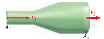
FIGURA 13.33 Fluido ideal que fluye a través de una tubería con un área de sección transversal variable.
