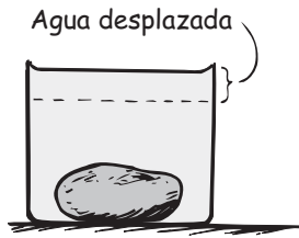
FIGURA 13.11 El aumento del nivel del agua es el mismo que se tendría si, en vez de poner la piedra en el recipiente, hubiéramos vertido en él un volumen de agua igual al volumen de la piedra.
