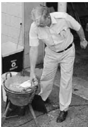
FIGURA 17.19 Paul Ryan prueba la temperatura del plomo derretido metiendo el dedo humedecido en él.
