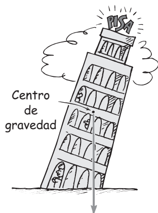
FIGURA 8.29 El centro de gravedad de la Torre Inclinada de Pisa está arriba de su base de soporte, y la torre está en equilibrio estable.
