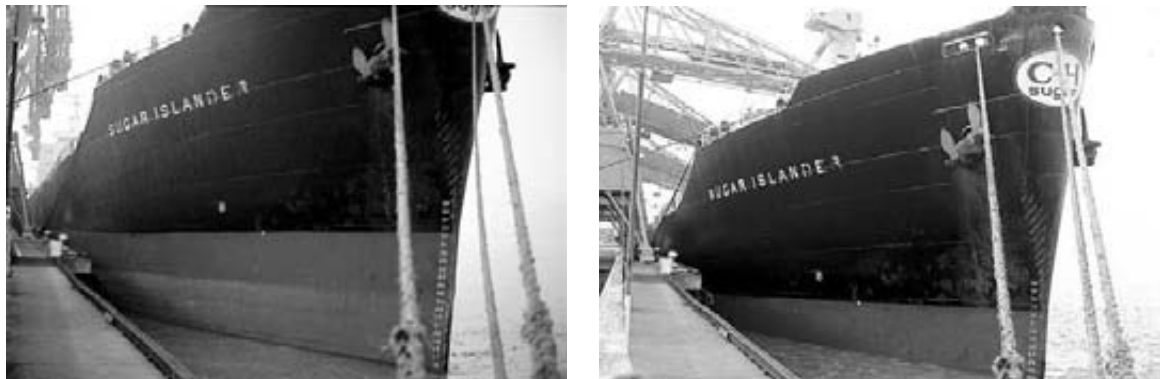
FIGURA 13.19 El mismo barco vacío y con carga. ¿Cómo se compara el peso de su carga con el peso del agua adicional desplazada?
