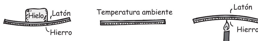
FIGURA 15.15 Banda bimetalica. El latón se dilata más que el hierro al calentarse, y se contrae al enfriarse. Debido a este comportamiento, la banda se flexiona como aquí se muestra.
