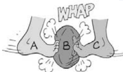
FIGURA 5.13 Tanto A como C actúan sobre B. Es posible que se anule entre sí, de manera que B no acelere.
