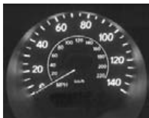
FIGURA 3.2 Este velocímetro da lecturas en millas por hora y en kilómetros por hora.
