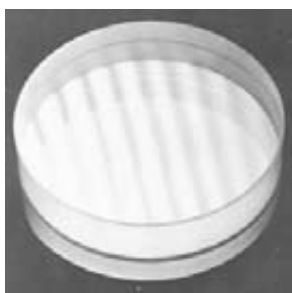
FIGURA 29.24 Planos ópticos para probar qué tan planas son las superficies.
