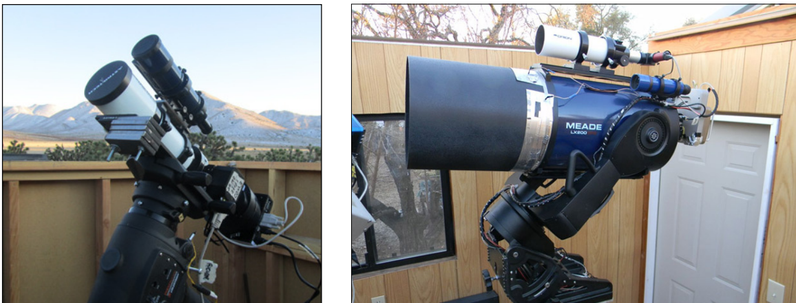
Dos de los telescopios de la red AAVSOnet: BSM-Hamrem, 65 mm, Astro-Tech AT-65EDQ (izquierda) y Coker 30, un Schmidt-Cassegrain de 30 cm, Meade LX-200 GPS (derecha).
